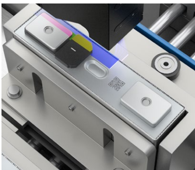
预焊电动汽车电池间隙和面差测量 (Gocator 2618)
