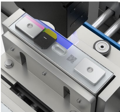
Inspección previa a la soldadura de la batería del EV con Gocator 2618
