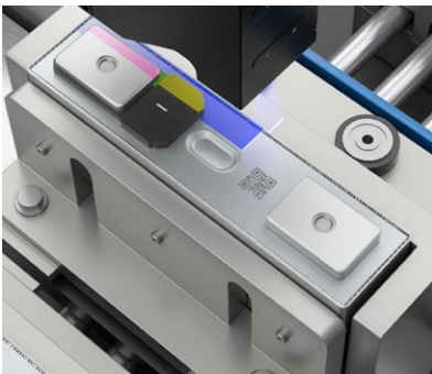
용접 전 전기차 배터리 셀 캡단차 측정 (Gocator 2618)
