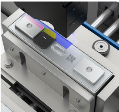
EV-Batterieprüfung vor der Schweißnaht mit Gocator 2618
