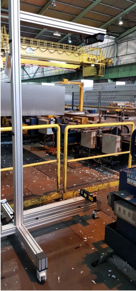
인라인 상하면 동시 스캔을 위하여 Gocator 센서 2개가 달린 맞춤 브래킷
