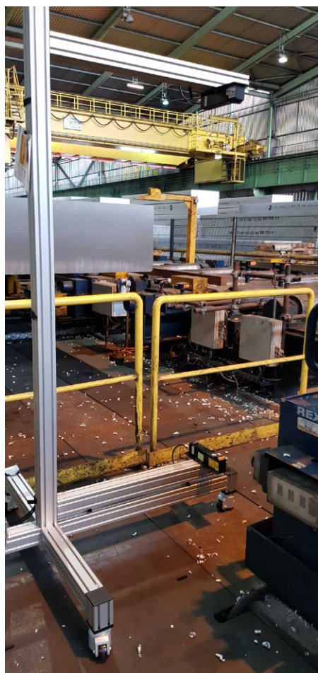
同時インライントップ/ボトム表面スキャン用の2台の Gocator センサーのあるカスタムブラケット
