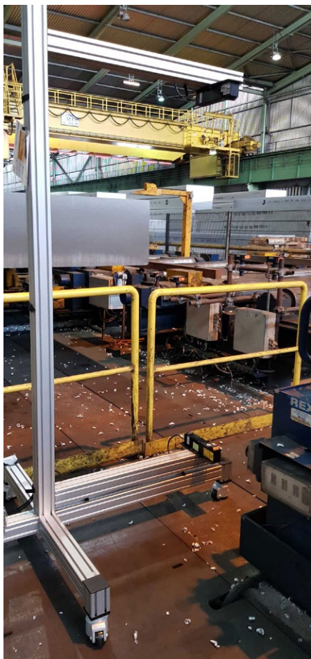
定制支架装有2台Gocator传感器,同时在线扫描顶部和底部表面
