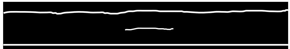
Der tomographische Querschnitt zeigt den dünnen Lufthohlraum als dritte Fläche im Profil
