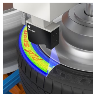
Prüfung der Gleichmäßigkeit der Reifenseitenwände
