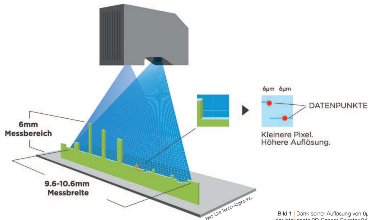
Bild 1 | Dank seiner Auflösung von 6µm kann der intelligente 3D-Sensor Gocator 2410 auch kleinste Merkmale erkennen.
